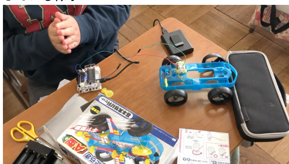
図3 音に反応してモーターを回転させるプログラミングしたマイクロコントローラを試している様子
