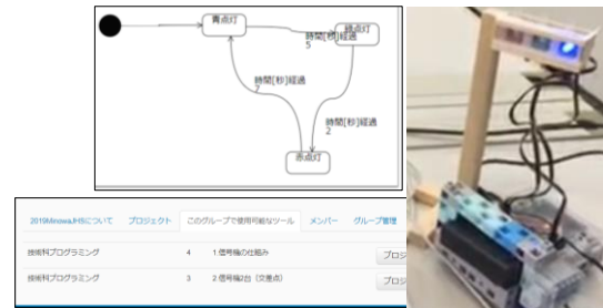
図 2 信号機設計用 UML プログラム例(左上)・信号機モデ(上右)・課題毎の開発環境 (下)
