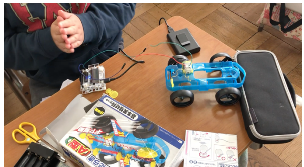
図3 音に反応してモーターを回転させるプログラミングしたマイクロコントローラを試している様子
