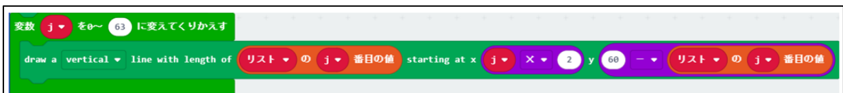
図2 拡張ディスプレイ上に配列内の64個の数値を棒グラフ形式で表示させるプログラム
