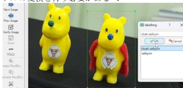
図 2 labelIMG による物体のアノテーション処理
